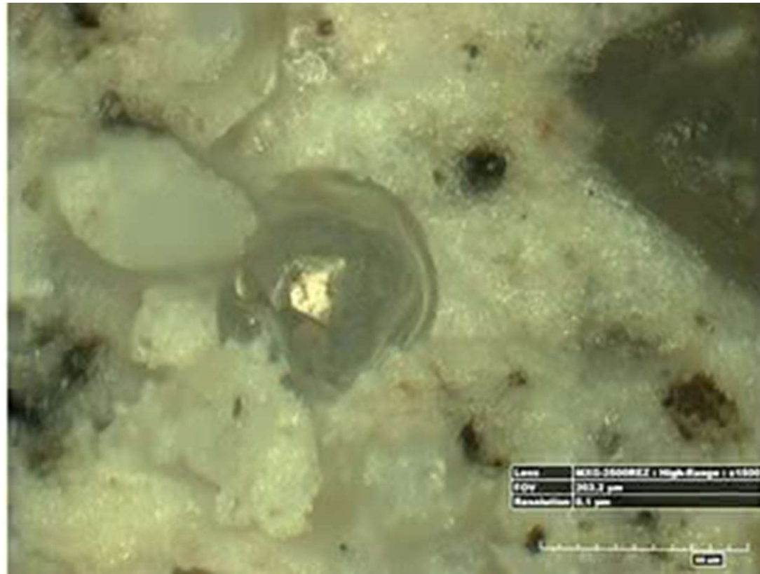
Mikrokapsułki w betonie
