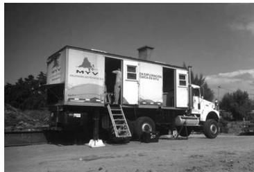
Fig. 12. 23 ton CPT truck.
